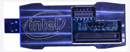
USB-Träger mit zwei neuromorphen Chips/Intel Loihi (Abbildung aus [1])
